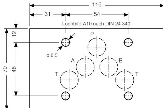
Diese Blind- oder Abdeckplatte wird z.B. als Abschluss eines Reserve-Lochbildes verwendet. Sie eignet sich auch zum Bohren spezieller Anschlüsse.
