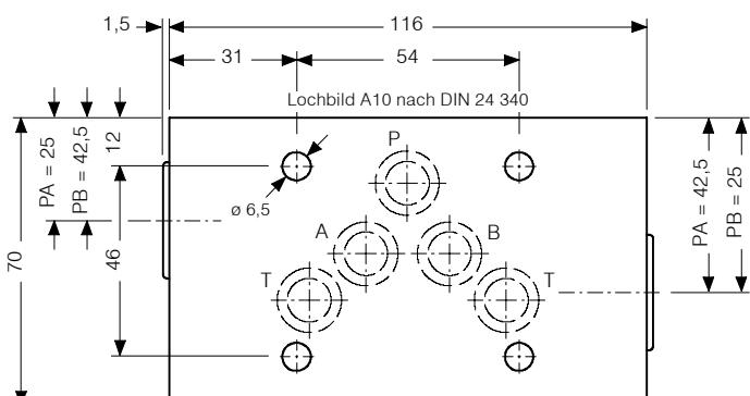
Mit der Wege-Abschlussplatte kann an Stelle eines Wegeventils eine unveränderliche Wegefunktion erzielt werden. Zusätzlich sind seitlich je 1 Anschluss G 1/2" in A und B vorhanden.
